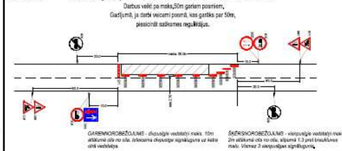
Loķīšs shēma B Satiksmes organizācijas shēma, veicot darbus vai mehāniskām atrodolēs uz brauktuvēs.
