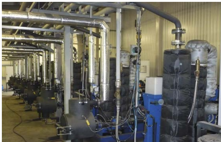
Attēlā redzama gaziifikatoru rinda, kas ražo gāzi no šķeldas (saražotā gāze darbina generatoru dzinējus)
